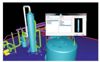
Hier wurde mit Leica Cyclone ein Anlagenbereich aus Punktwolken modelliert. Der Anwender hat den stehenden Behälter in seiner Modell-Bibliothek gespeichert. Dieses neue Feature in Cyclone 8.0 erlaubt es, das Modell an einer weiteren Stelle der Anlage zu verwenden, wo der gleiche Behälter steht. Der Anwender kann ihn auch für zukünftige Projekte einsetzen und mit anderen Projektbeteiligten gemeinsam nutzen.
