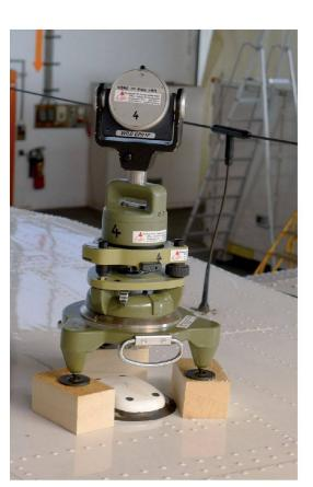
Fig. 4: Prisme au-dessus de l'antenne GNSS.
