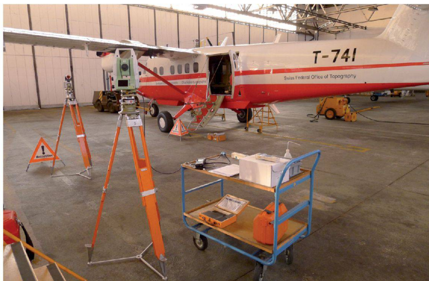
Fig. 5: Mensuration par intersection de directions depuis deux stations.
