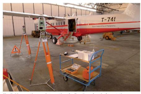
Fig. 5: Mensuration par intersection de directions depuis deux stations. *Abb. 5: Vermessung durch Einschnitte der Distanzen von zwei Stationen aus.* Fig. 5: Misurazione tramite intersezione delle distanze da due stazioni.
