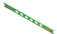
Fig. 11: La poutre type «Angelina» avec la coloration des déformations (les parties rouges et bleues représentent des défauts principaux allant jusqu'à 8 mm).
