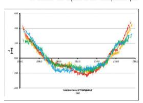
Fig. 12: Pour la même poutre, représentation des défauts de rectitude des quatre arêtes en planimétrie.
