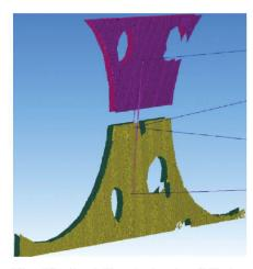
Fig. 10: Contrôle de la planéité des faces.
