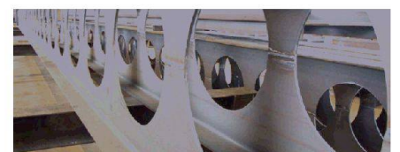
Fig. 1: Profilé ajouré type ACB, source ArcelorMittal.
