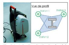
Fig. 4: La Leica ScanStation2 et le schéma du relevé.
