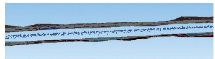
Fig. 9: Extrait d'un contrôle avec les modélisations de détail et, au centre, la moyenne calculée des 2 faces, via la numérisation globale.
