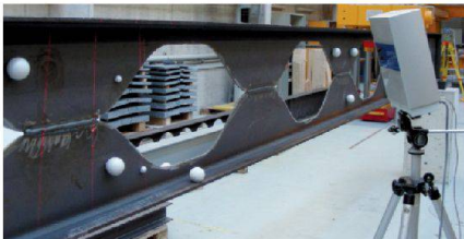
Fig. 6: Le Next Engine et les sphères communes aux deux scanners.
