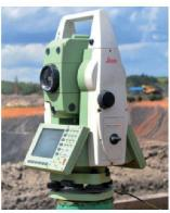
Das automatische Sortieren von Punkten erlaubt einen effizienteren Messablauf, beispielsweise im Tagebau, wo oft Hunderte von Prismen installiert sind.
