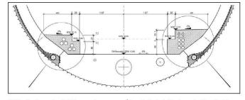
Abb. 3: Ausschnitt Tunnelquerprofil mit Rohrblöcken in Banketten. Fig. 3: Extrait d'une coupe du tunnel avec les groupes de tubes dans les banquettes.
