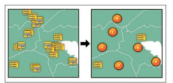
Abb. 3: Punktgeneralisierung durch Clustering.
