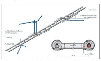
Abb. 2: Tunnelsystem (schematisch) mit Querschlagsquerschnitt (Quelle: www.alptransit.ch).
