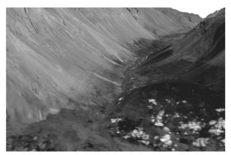
Abb. 2: 3D-Darstellung des DOM mit 5 m Maschenweite aus LPS eATE, basierend auf der uneditierten Punktwolke, überlagert mit dem orthorektifizierten panchromatischen Knal einer WorldView-2 Szene.
