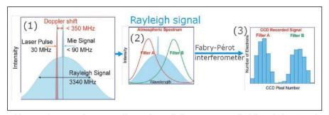
Abb. 3: Schematische Darstellung des reflektierten Signals (1) und des Detektors (2) mit der Abbildung auf dem CCD-Chip (3).
