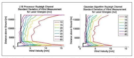
Abb. 4: Resultate der Prozessierung von Windmessungen mit dem klassichen Prozessor (L1B Processor, links) sowie der neuen Methode mit analytischen Ansatz (Gaussian Algorithm, rechts). Die Kurven repräsentieren die Standardabweichung für Signale mit verschiedener Intensität (Energie in mJ). Die Genauigkeit ist vor allem für tiefe Energie (10 mJ, rot) besser mit der neuen Methode.
