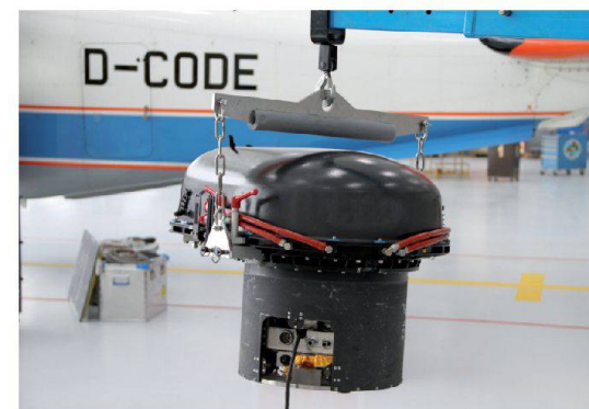
Abb. 1: Der APEX Sensor fertig zum Einbau in die bereitstehende DO-228 D-CODE des Deutschen Luft- und Raumfahrtzentrums DLR in Oberpfaffenhofen, Deutschland.
