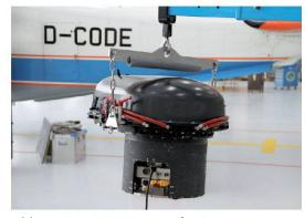
Abb. 1: Der APEX Sensor fertig zum Einbau in die bereitstehende DO-228 D-CODE des Deutschen Luft- und Raumfahrtzentrums DLR in Oberpaffenhofen, Deutschland.
