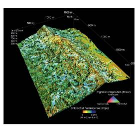
Abb. 2: Chlorophyllfluoreszenz und Pigmentzusammensetzung gemessen mit APEX und überlagert auf LIDAR Daten (Lägeren, Schweiz; Daten: RSL).
