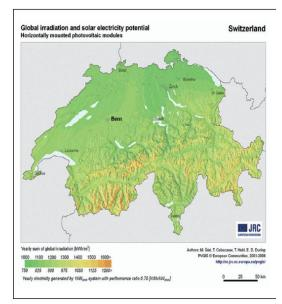
Abb. 2: Globalstrahlung und Energiepotenzial auf eine horizontale Fläche in der Schweiz. (Quelle: Joint Reseach Center, Institute for Energy and Transport http://re.jrc.ec.europa.eu/pvgis.)
