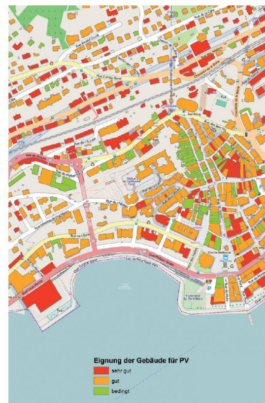
Abb. 3: Ausschnitt der Stadt Neuchâtel. Eignung der Gebäude für Photovoltaik-Anlagen.
