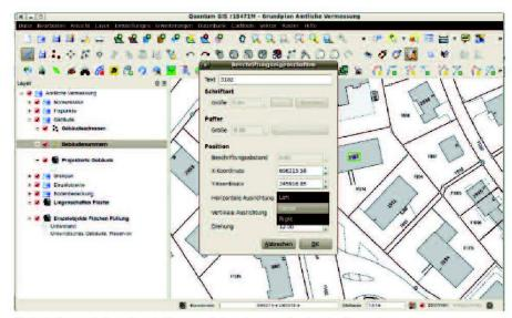
Abb. 1: Interaktiver Beschriftungsdialog (manuelle Beschriftung).
