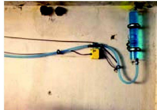
Abb. 7: Schlauchwaagensensor mit Ausgleichsgefäss.
