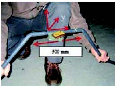
Abb. 8: tShape-Segmente mit angelegter Ausrichtung der Sensoren.
