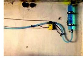
Abb. 7: Schlauchwaagensensor mit Ausgleichsgefäss.
