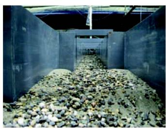
Fig. 2: Laboratoire LCH: Essai sur modèle physique en laboratoire simulant les conditions en l'absence du seuil: vue du chenal principal sur l'embouchure élargie de son affluent; suite à l'élargissement de l'embouchure, la morphologie du fond se diversifie, créant des conditions favorables à l'émergence de nouveaux habitats et à la libre circulation des poissons (LCH/EPFL).
