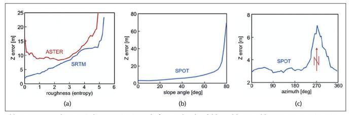
Abb. 1: Zusammenhang zwischen Terrain-Eigenschaften und Höhenfehlern: (a) Der Fehler von SRTM steigt mit zunehmender Rauigkeit, während er anfangs für ASTER sinkt – sehr geringe Rauigkeit heisst oft auch wenig Textur für die Bildkorrelation; (b) Die Fehler von SPOT Reference3D korrelieren mit der Neigung; (c) SPOT überfliegt die Schweiz morgens gegen 10:30, daher gibt es Schatten auf Nordhängen, die zu Zuordnungsfehlern führen.
