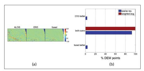
Abb. 4: Fusionsergebnis ALOS – ERS: (a) Keine Verbesserung, das Ergebnis ist im gesamten Testgebiet praktisch identisch mit dem ERS-DHM; (b) die quantitative Analyse bestätigt: es gibt kaum Änderungen gegenüber ERS.
