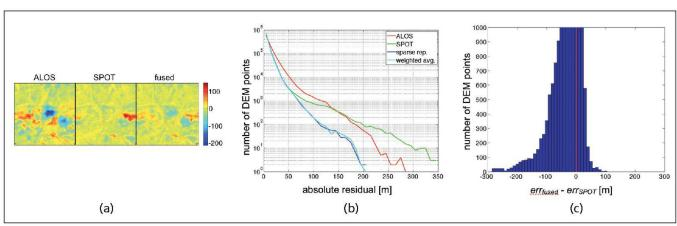
Abb. 2: Fusionsergebnisse ALOS – SPOT: (a) Beispiel für die Reduktion grober Fehler in den Eingabedaten; (b) Histogramme der absoluten Fehler; (c) Fehlerdifferenzen zwischen Fusionsergebnis und SPOT DHM (negative Werte bedeuten Verbesserung).
