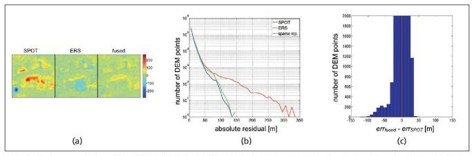
Abb. 3: Fusionsergebnisse ERS – SPOT: (a) Beispiel für die Reduktion grober Fehler in den Eingabedaten; (b) Histogramme der absoluten Fehler; (c) Fehlerdifferenzen zwischen Fusionsergebnis und ERS DHM (negative Werte bedeuten Verbesserung).
