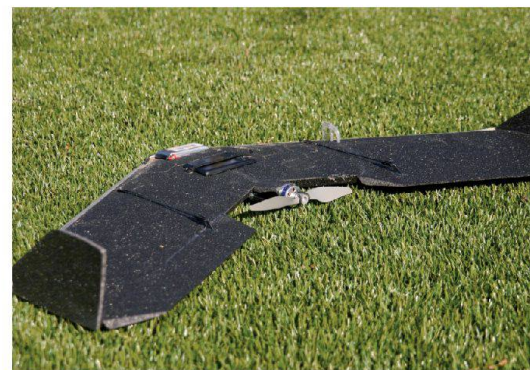
Fig. 1: L'aile prête au décollage, avec batterie, caméra et moteur+hélice.
