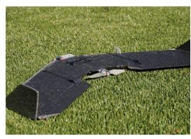
Fig. 1: L'aile prête au décollage, avec batterie, caméra et moteur+hélice.
