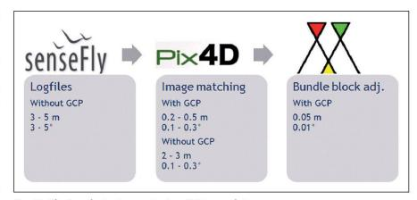
Fig. 2: Chaîne de traitement et précisions obtenues.
