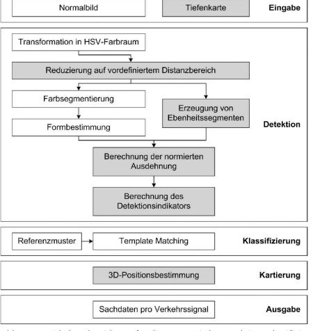
Abb. 3: Entwickelte Algorithmen für die automatische Detektion, Klassifizierung und Kartierung von farbigen Verkehrssignalen (graue Felder: Operationen nutzen die Tiefeninformation).
