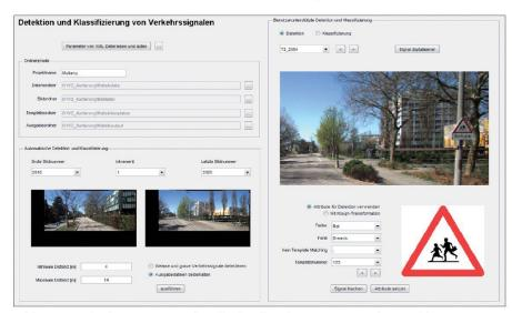
Abb. 5: Grafische Benutzeroberfläche für die automatische und benutzerunterstützte Detektion, Klassifizierung und Kartierung von Verkehrssignalen.
