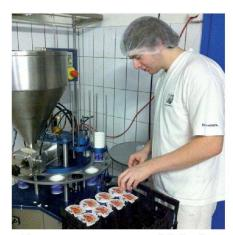
Abb. 2: Die neue Jogurtabfüllanlage in Betrieb.
