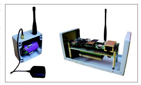
Fig. 1: Module d'acquisition et passerelle embarquée.
