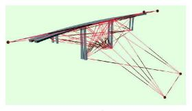
Fig. 2: Canevas des mesures terrestres avec les points de liaison.
