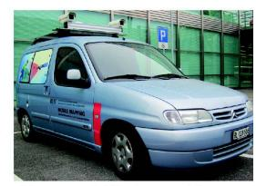
Abb. 2: Stereobild-basiertes Mobile Mapping System des IVGI.
