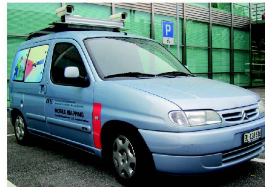
Abb. 2: Stereobild-basiertes Mobile Mapping System des IVGI.
