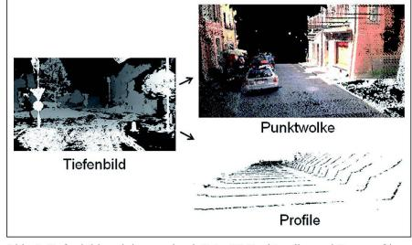
Abb. 4: Tiefenbild und daraus abgeleitete 3D-Punktwolke und Querprofile.
