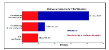
Fig. 3: Temps de calcul pour géoréférencer 106 mesures laser.
