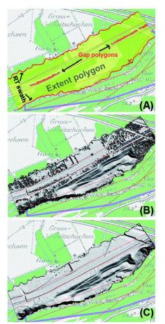
Fig. 1: Affichage de différents résultats du traitement en vol du nuage de points: (A) Limites de l'emprise, étendue des données et des lacunes, (B) ombrage du modèle de surface, (C) ombrage du modèle de terrain.
