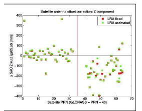
Abb. 3: GNSS-Satellitenantennenoffsets aus einer gemeinsamen GNSS-/ SLR-Auswertung ohne bzw. mit gleichzeitiger Schätzung der SLR-Reflektoroffsets.
