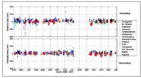
Abb. 4: SLR-Residuen der am AIUB bestimmten GOCE-Bahn.
