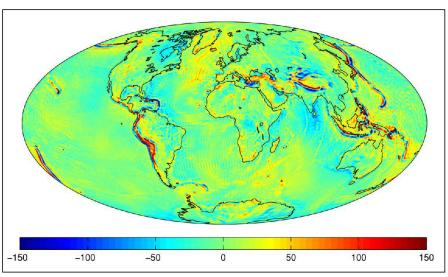
Abb. 2: Schwereanomalien in mgal, abgeleitet aus dem Modell AIUB GRACE03S.
