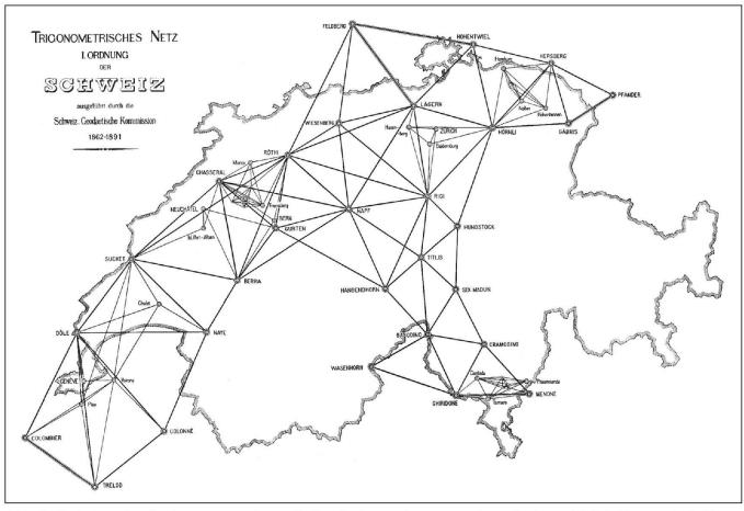
Abb. 2: Netzplan des Gradmessungsnetzes mit den Basisvergrösserungsnetzen Aarberg, Weinfelden und Giubiasco (Zölly, 1948, S. 68).
