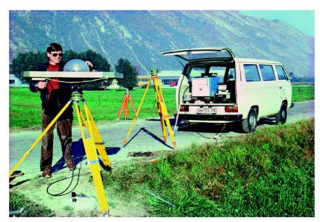
Abb. 8: Die ersten GPS-Messungen mit dem Macrometer V-1000 im Jahre 1985, SGK Band 51, S. 10.
