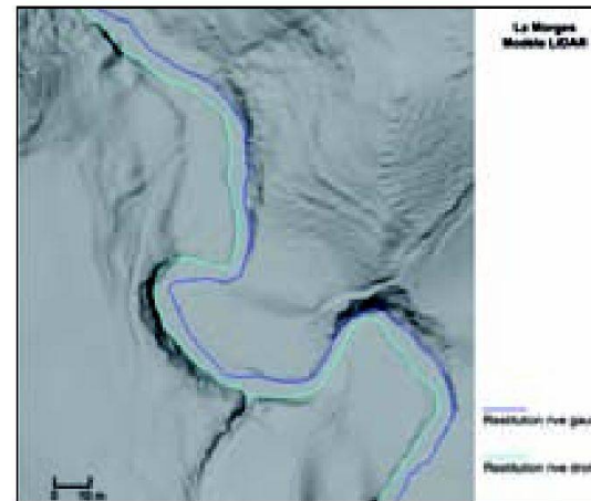
Fig. 1: Représentation de la restitution des limites LIDAR superposée au MNT de maille 0.5 m.
