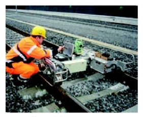
Abb. 3: Gleismesswagen RACER.
