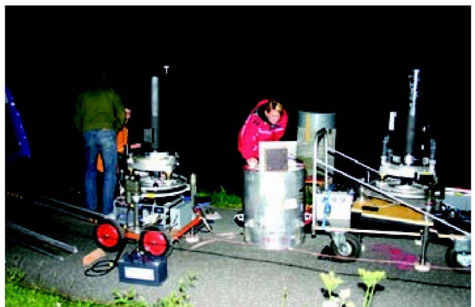
Abb. 5: Die beiden digitalen Zenitkamera-Systeme der Leibniz Universität Hannover (links) und der ETH Zürich (rechts) im Einsatz bei der Messung des Portalfeilers Erstfeld (im Hintergrund sichtbar).
