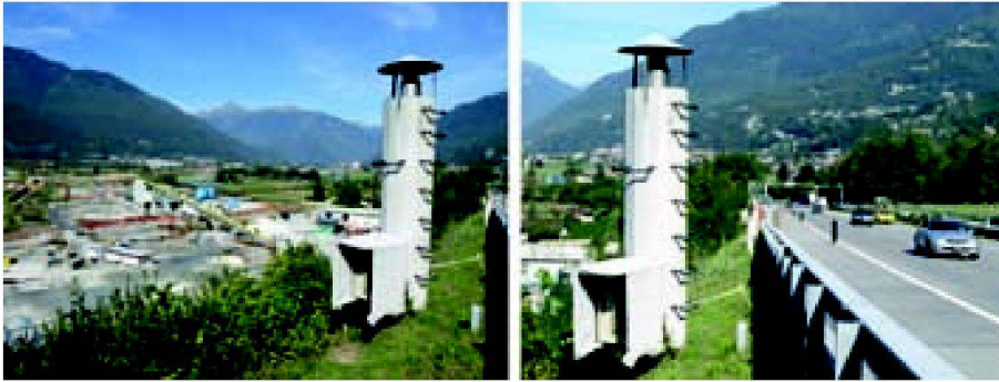
Abb. 2: Messpfiler: Automatische Überwachung entlang der Autobahn A2 – das Monitoringsystem detektiert Bewegungen mit einer vorgegebenen Sensitivität von 3 mm.
