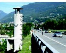
Abb. 2: Messpfeiler: Automatische Überwachung entlang der Autobahn A2 – das Monitoringsystem detektiert Bewegungen mit einer vorgegebenen Sensitivität von 3 mm.
