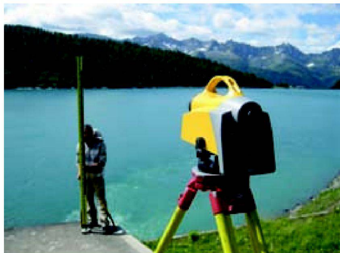
Abb. 4: Nivellementmessung beim Ritomsee.
