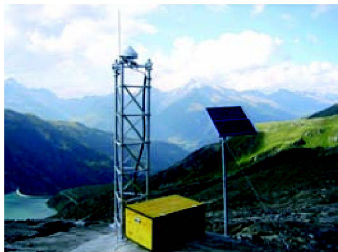
Abb. 6: GPS-Anlage oberhalb des GBT-Trassees bei Mauer Nalps.
