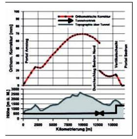
Abb. 5: Orthometrische Korrekturen a priori im Tunnel ausgehend von orthometrischen Höhen in den Portalen.
