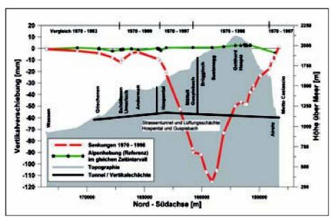
Abb. 6: Senkungen am Gotthardpass aufgrund des Baus des Strassentunnels [Schlatter 2007].
