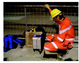
Abb. 4: Schweremessung im Tunnel.
