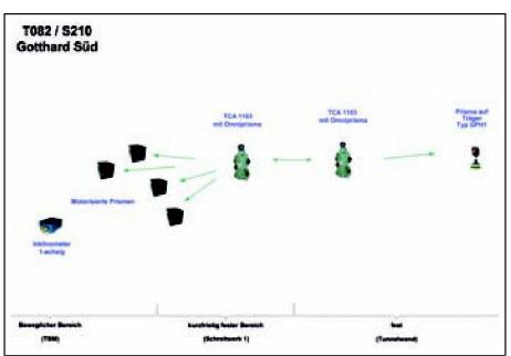
Abb. 5: Komponenten des Steuerleitsystems.
