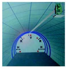
Abb. 1: Motorlaser mit Massen zum Ringeinbau.
