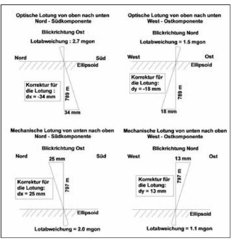
Abb. 9: Lotkrümmungs-Korrektur der Koordinatenübertragung im Vertikalschacht.
