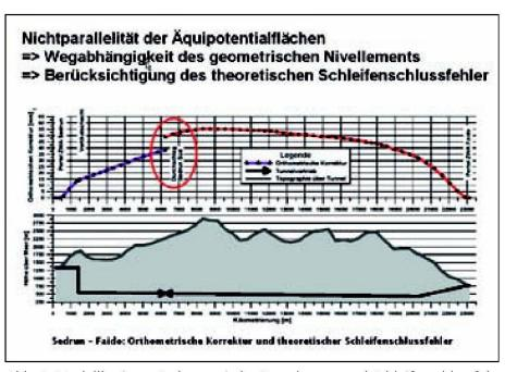
Abb. 2: Modellbasierte Orthometrische Korrekturen und Schleifenschlussfehler des Nivellements.
