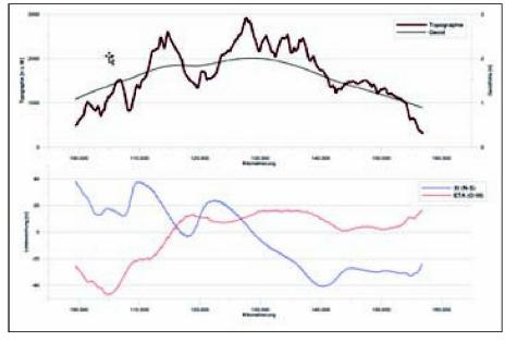
Abb. 1: Topographie, Geoid und Lotabweichungskomponenten auf der GBT-Tunnelachse.
