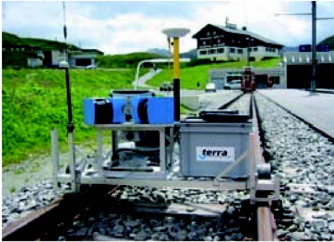
Abb. 6: Gleismesswagen Swisstrolley (terra) und RACER (UniBw).
