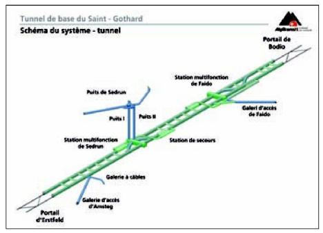
Fig. 1: Le système de tunnel au Gothard.
