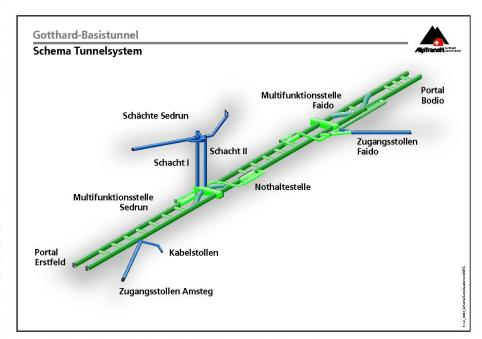
Abb. 1: Das Tunnelsystem des Gotthard-Basistunnels.
