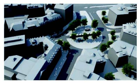
Fig. 4: Représentation de Plainpalais avec ombrage, mais sans texture, fidèle au niveau de détail genevois (LoD 1b).
