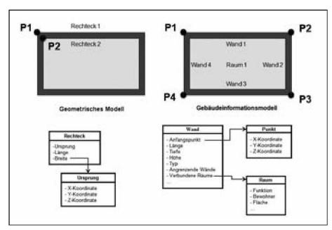
Abb. 3: Unterschiede Geometrisches Modell - Gebäudeinformationsmodell.
