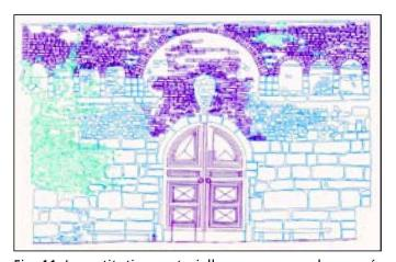
Fig. 11: La restitution vectorielle par scannage laser, exécutée avec différents «layer» (briques, pierres, végétation).
