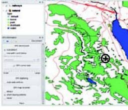
Abb. 5: Der GPS-Tracker erlaubt die Live-Erfassung von Objekten und das Aufzeichnen von Bewegungen.
