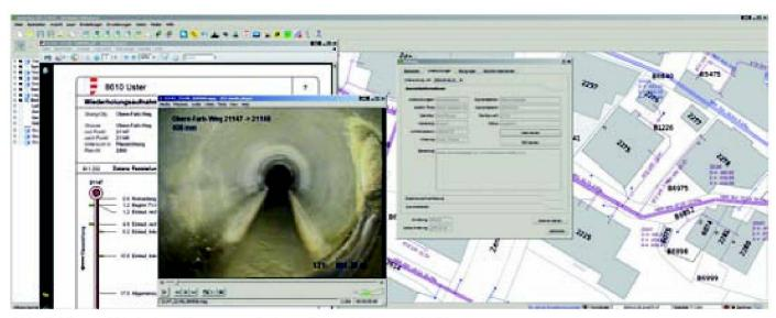
Abb. 1: Viewer Werkplan Abwasser mit Formularen, Video und PDF.
