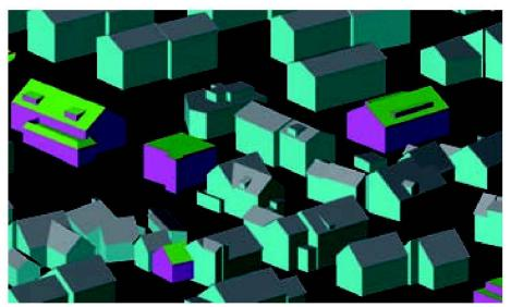
Abb. 2: 3D-Gebäudemodelle aus der photogrammetrischen Auswertung von Stereoluftbildern.
