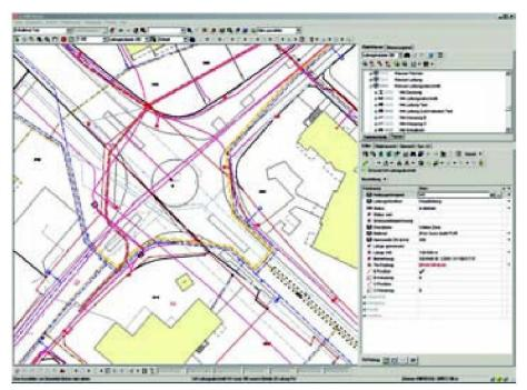
Abb. 3: Leitungskataster, Energie Uster AG.
