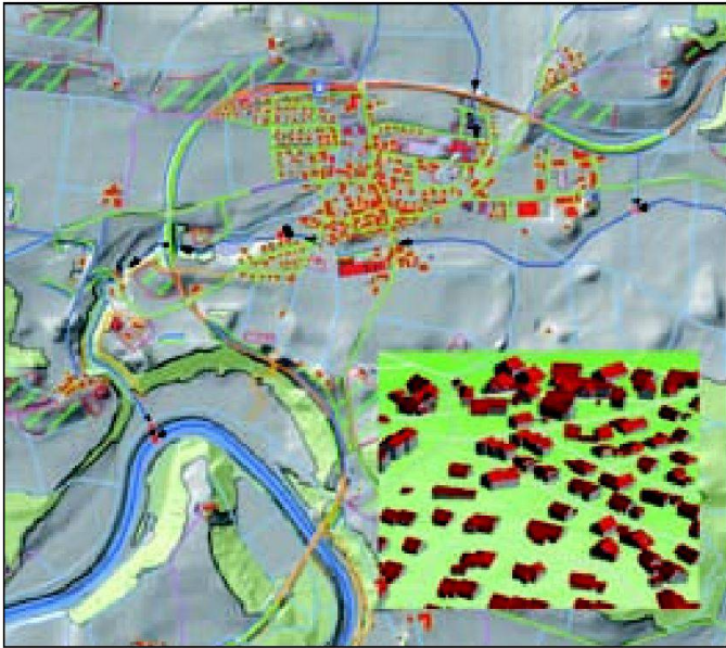
Abb. 1: TLM mit schattiertem Geländemodell, Ausschnitt Ossingen. Die Vergrößerung im rechten unteren Teil der Abbildung zeigt 3D-Dachflächen im TLM.
