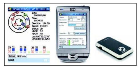
Abb. 2: GPSInfo Software (links), PDA mit GeoDataSnapper-Software (mitte) und Bluetooth-GPS-Empfänger (rechts).
