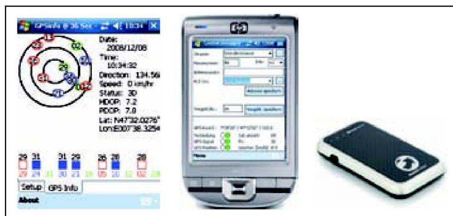
Abb. 2: GPSInfo Software (links), PDA mit GeoDataSnapper-Software (mitte) und Bluetooth-GPS-Empfänger (rechts).
