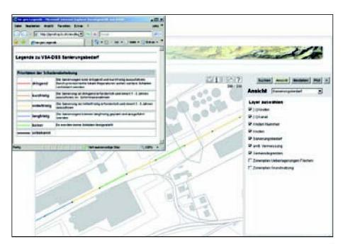
Abb. 5: Beispiel Sanierungsbedarf, Visualisierung Geoshop Raumdatenpool Luzern.
