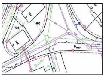
Abb. 2: Ausschnitt Leitungskataster 1: 500, Musterplan aus SIA 405 2015 (2005).
