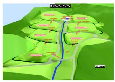
Abb. 4: Retentionsbauwerke (3D-Modell).
