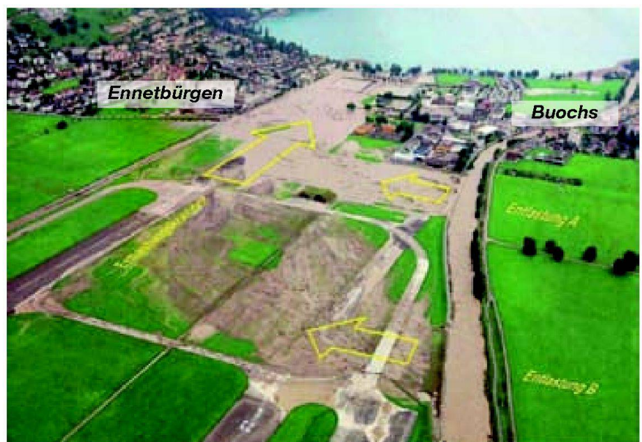
Abb. 4: Die Engelberger Aa beim Abklingen des Hochwassers 2005. Das «Zuviel» an Wasser verlässt das Flussbett an den vorgesehenen Stellen und strömt durch den Entlastungskorridor zwischen Ennetbürgen und Buochs dem Vierwaldstättersee zu. Im Flussbett verbleiben maximal 150 m³/s (Luftbild: Luftwaffe).
