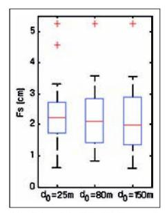
Abb. 4: Boxplot mit Restklaffungen Fs in den Kontrollpunkten nach Interpolationsvariationen mit TRANSINT (Maschenweite  $d_0$ ).
