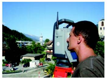
Abb. 1: Tachymeter-Messung.
