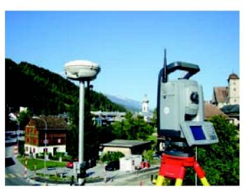
Abb. 2: Messung mittels GPS.
