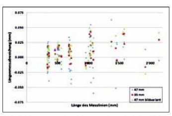
Abb. 8: Längenmessabweichungen der getesteten Objektive. Mit bildvarianter Kalibrierung sinkt die maximale Längenmessabweichung beim 47-mm-Objektiv von 0,063 auf 0,050 mm. Beim 35-mm-Objektiv beträgt die grösste Längenmessabweichung 0,043 mm.
