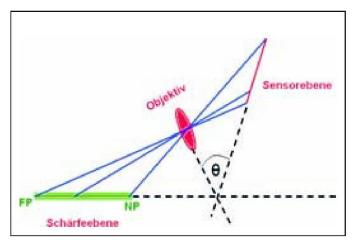
Abb. 4: Durch Verschenken der Objektivebene zur Sensorebene reicht die Schärfeebene im Objektraum von Nah(NP)- bis Fernpunkt (FP) auf dem aufzunehmenden Handstück. Der Scheimpflugwinkel (θ) betrug in diesem Fall ungefähr 20°. Schärfeebene, Objektivebene und Sensorebene schneiden sich in einem Punkt in der Abbildung.
