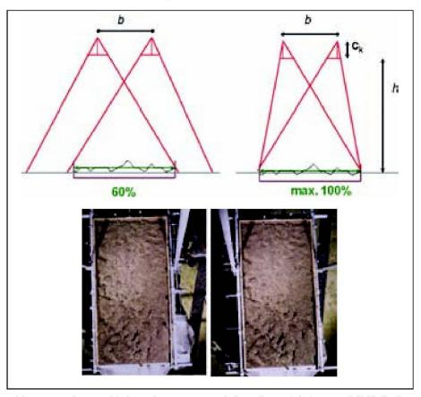
Abb. 3: Durch Verschieben der Hauptpunktlage lässt sich im Zweibildfall eine Stereoüberlappung von bis zu 100% erreichen (Grafik oben). Auf diese Art wird der Sensor optimal ausgenutzt. Die Basis (b) zwischen den Kameras kann dabei erhalten bleiben, Kammerkontante (c<sub>k</sub>) und Flughöhe (h) werden nicht beeinflusst. Im Bildbeispiel (unten) wurde durch einen Versatz der Hauptpunktlage um 8 mm der Stereobereich von 60 auf 77% erweitert.
