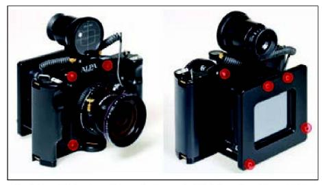
Abb. 6: Alpa 12 Metric mit 35-mm-Rodenstock-Objektiv und Leaf Aptus 75 Digitalrückteil. An den rot markierten Stellen wurde die Kamera mit Schrauben stabilisiert. Das Rückteil wird von hinten an den Kamerakörper angedrückt.
