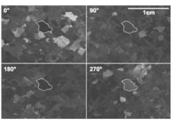
Abb. 5: Von jedem Handstück wurde die Marmoroberfläche aus vier verschiedenen Blickrichtungen aufgenommen, da je nach Richtung der Beleuchtung bzw. Aufnahmeblickwinkel die Reflexion der einzelnen Kalzit-Kristalle unterschiedlich ist.
