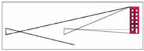
Abb. 1: Eine Kamera mit versetzter Hauptpunktlage (Mitte) ermöglicht eine optimale Ausnutzung der Sensorfläche bei der Aufnahme von hohen Objekten und Ausrichtung des Sensors parallel zur Fassade. Der effektive Bildmassstab ist grösser als bei einer normalen Kamera. Auf diese Art lassen sich terrestrisch Hausfassaden, geologische Aufschlüsse oder ähnliche Objekte erfassen.
