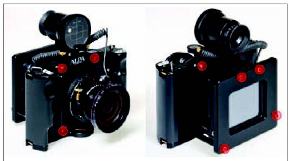
Abb. 6: Alpa 12 Metric mit 35-mm-Rodenstock-Objektiv und Leaf Aptus 75 Digitalrückteil. An den rot markierten Stellen wurde die Kamera mit Schrauben stabilisiert. Das Rückteil wird von hinten an den Kamerakörper andrückt.
