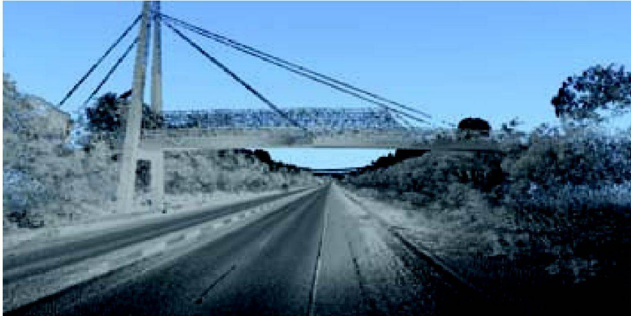
Abb. 8: Laserscanning mit StreetMapper 360 (360° Blickfeld), Grauwertdarstellung.
