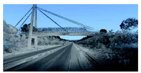
Abb. 8: Laserscanning mit StreetMapper 360 (360° Blickfeld), Grauwertdarstellung.
