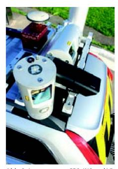
Abb. 3: Laserscanner, GPS, INS und Videosystem.
