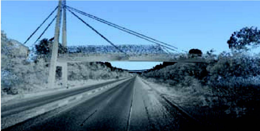
Abb. 8: Laserscanning mit StreetMapper 360 (360° Blickfeld), Grauwertdarstellung.
