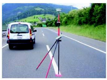
Abb. 4: Passpunktmessung mittels GPS.
