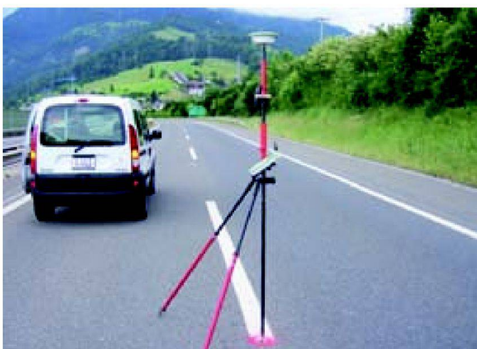
Abb. 4: Passpunktmessung mittels GPS.
