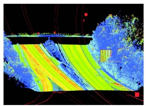
Abb. 6: Beispiel Punktwolkenausschnitt mit automatisch generierten Vektorelementen.
