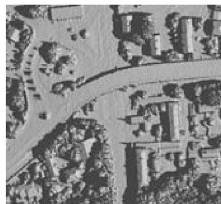
Abb. 2: Ausschnitt eines aus Laserdaten abgeleiteten Digitalen Oberflächen-Modells der Stadt Genf (4 P/m 2 , 0.5 m Raster).
