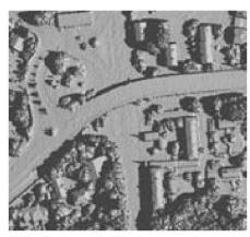
Abb. 2: Ausschnitt eines aus Laserdaten abgeleiteten Digitalen Oberflächen-Modells der Stadt Genf (4 P/m², 0.5 m Raster).
