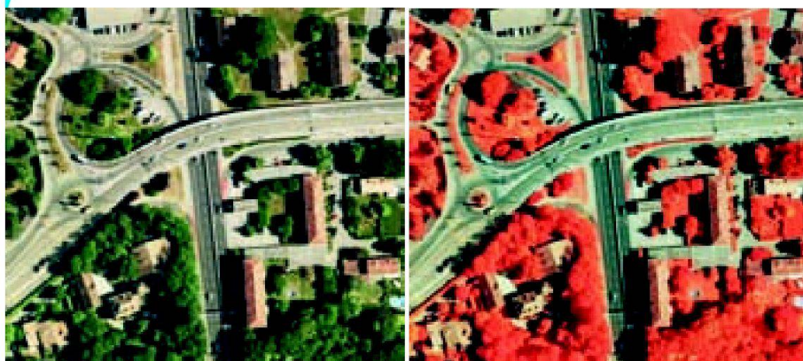
Abb. 1: Ausschnitt aus dem Digitalen Orthophoto der Stadt Genf (10 cm Auflösung, links: RGB, rechts: CIR).
