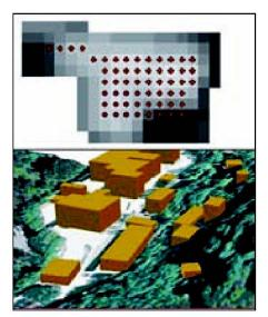
Abb. 5: Gebäudemodellierung aus Grundrissen und Höhen des digitalen Oberflächenmodells.
