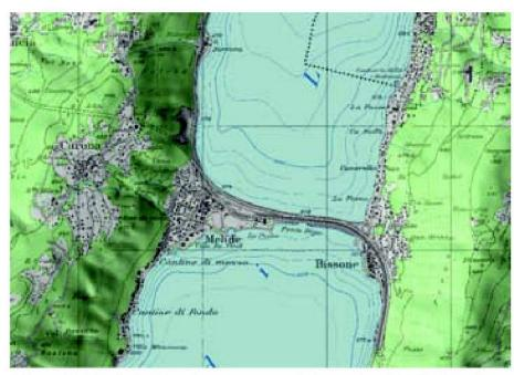
Abb. 2: Melide. Reliefschattierung automatisch aus dem DHM25 berechnet. Darstellung in der Landeskarte 1:25000. Daten Bundesamt für Landestopografie. Verarbeitung mit RAVIS (M. Zanini).
