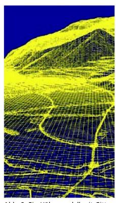
Abb. 8: Ein Höhenmodell mit Gitterund TIN-Struktur, um das Gelände in der Umgebung von Strassen realistischer darzustellen.
