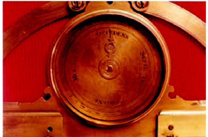
Abb. 4: Bussole (Nadel und Abdeckung fehlen).
